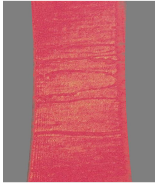
Obr. 2. Obraz výbojovej medzery pri aplikovanom napätí 1,2 kV a vzdialenosti elektród 0,4 mm. Fig. 2. The picture of discharge gap at the applied voltage 1,2 kV and gap distance 0,4 mm.
